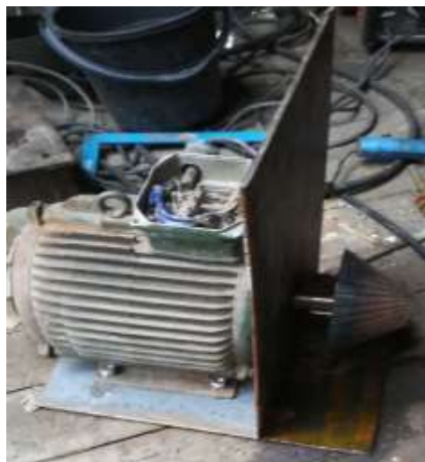
Рисунок 3 – Электродвигатель в агрегате с барабаном
