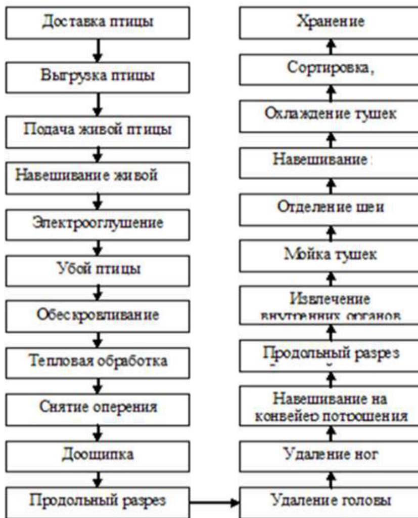
Рисунок 1 - Схема производства охлажденных цыплят-бройлеров
