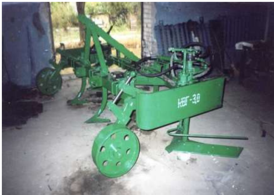
Рисунок 2- виноградниковая почвообрабатывающая машина КВГ-3
