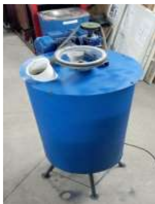
Рисунок 3 – Опытный образец вертикальной протирающей машины
