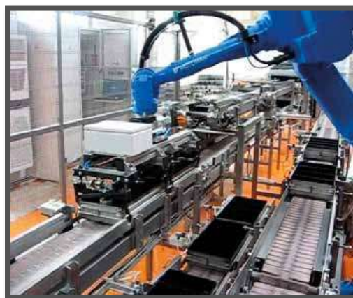
Рисунок 2 – Пример автоматизированной системы управления формами и крышками
